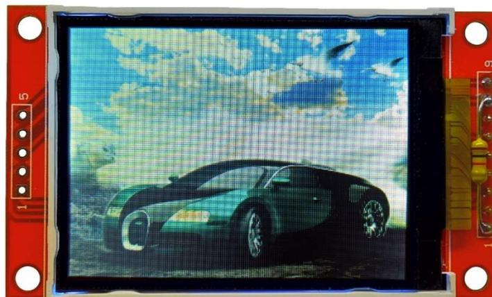
Abb. 1: Zugzielanzeiger BMP\_TFT22
