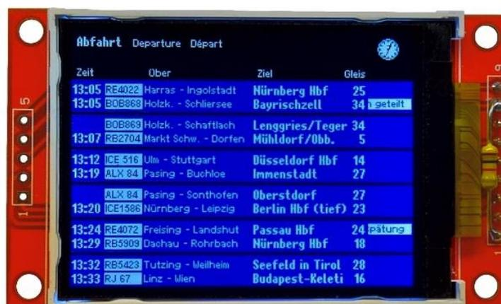
Abb. 1: Zugzielanzeiger DB\_TFT22
