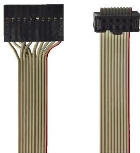
Abb. 22: links Stecker Display, rechts Stecker Steuerplatine
