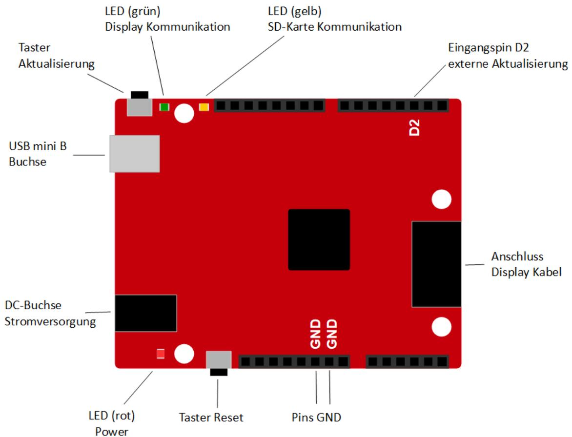
Abb. 21: Übersicht Steuerplatine
