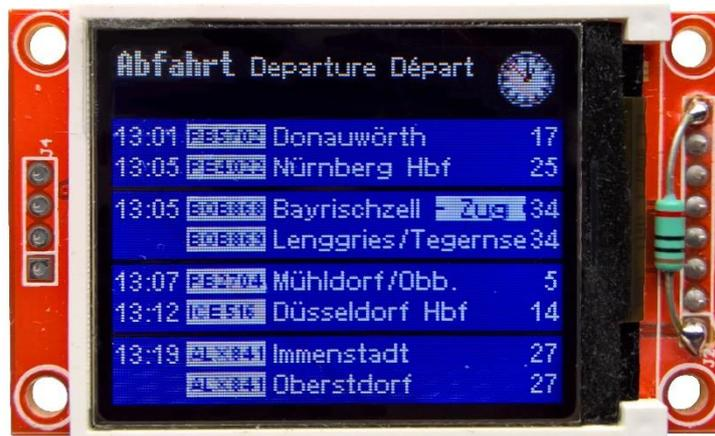
Abb. 1: Zugzielanzeiger TFT18 als DB Hallenanzeiger
